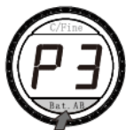
La suma de la carga de las baterías A y B
