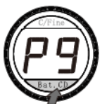
La suma de la carga de las baterías C y D
